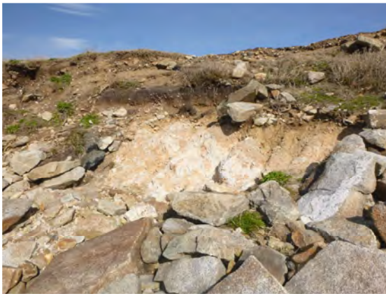
au droit du profil P50, micro-falaise de \sim 2.5 \text{ m} de haut entaillée dans un horizon basal argileux très humide dominé par un niveau tourbeux ( 0.2 \text{ m} ) puis un horizon d'altérites composé d'arène, de blocs et de gravats ( 1.2 \text{ m} )
